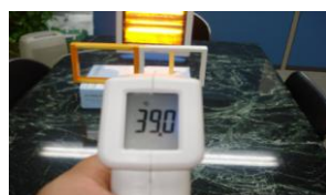
施工済みガラス測定
