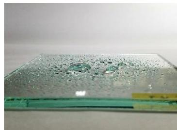
コーティング塗布面は水滴を弾き、接触角度が大きく水滴が流れる
